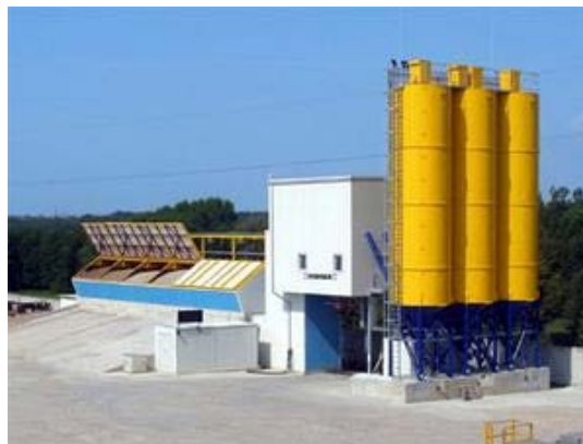
Фото 1 - Зовнішній вигляд бетонозмішувальної установки ВЕТОМІХ 2,25-А-Р/РІМ-М, фірми LIEBHERR-MISCHTECHNIK GmbH, ФРН
